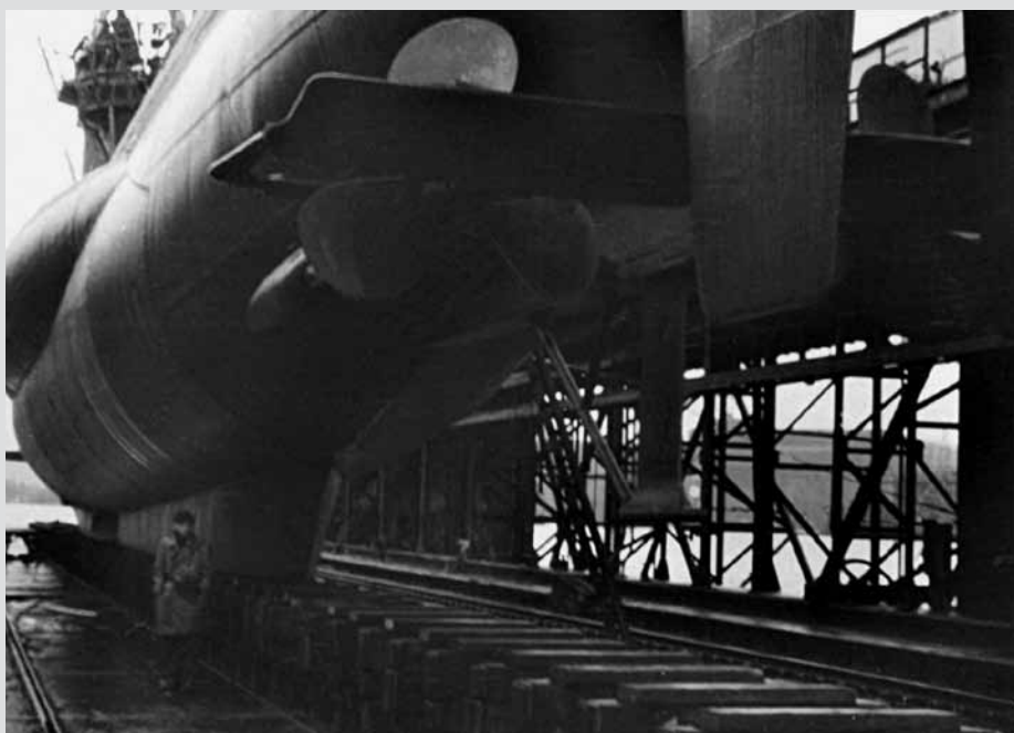
U291 im Dock zum Wechsel der Schrauben
